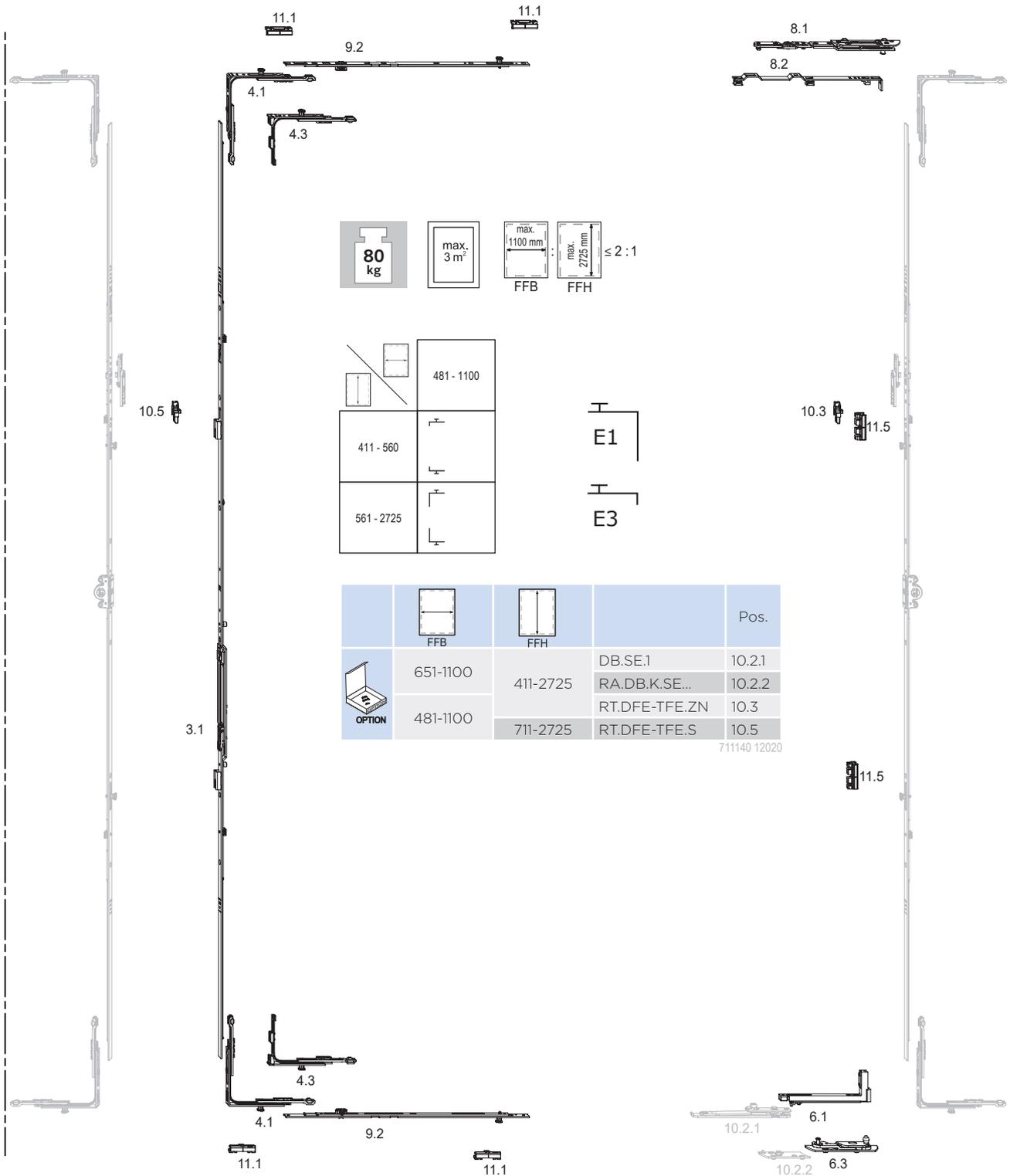
80 kg    max. 3 m<sup>2</sup>    max. 1100 mm FFB    max. 2725 mm FFH    k 2:1
